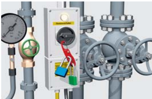
Bild 2: Revisionsschalter (indirekt) Die Meldeleuchte muss bei ausgeschalteter Anlage aufleuchten.
