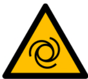
Bild 3: Warnschild „Unerwarteter Anlauf“ auf der Abdeckung von Schützen
